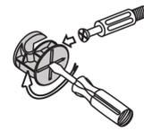
The head of the mini fix housing goes into the open mouth of the mini fix bolt. You then turn the mini fix housing so it tightens over the mini fix bolt.
